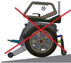
Abstützen bei 11% Gefälle
